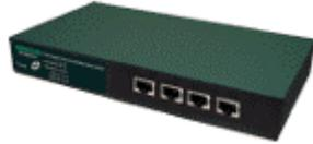
SURECOM的 **EP-804CG/EP-804CG-S** 是針對 SME 及 SOHO 使用者去增加骨幹頻寬所設計的.具有 4 埠 1000BASE-T 及桌上型設計,讓使用者易於安裝且昇級至 Gigabit 骨幹頻寬, **EP-804CG/EP-804CG-S** 提供了完美的高速傳輸網路環境以解決頻寬不足之困擾.
